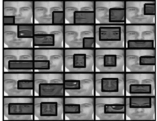
図 3 Spatial codebook の一例：各ブロックが顔領域を表している。その中の更に小さな局所領域は選択された spatial codeword の位置を表している。
